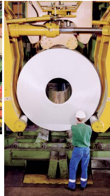
Aluminium-Coil im Zangenkran.
