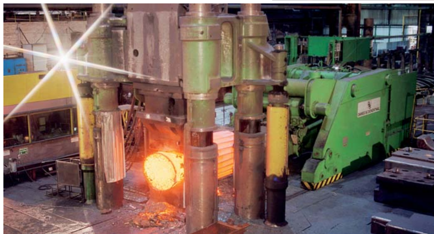
Freiformschmiedepresse mit Manipulator.
