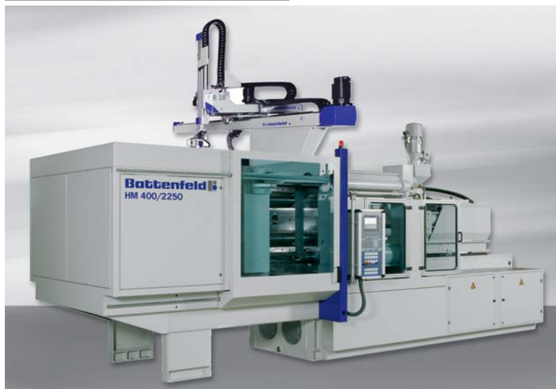
HM 400/2250, kompakte horizontale Spritzgießmaschine.
