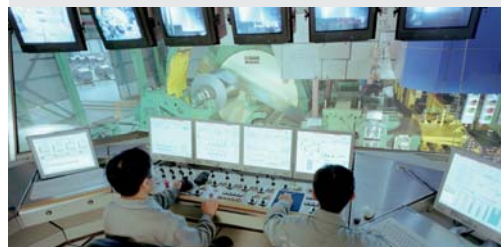
Karussellhaspel in einer Tandem-Kaltwalzanlage.
