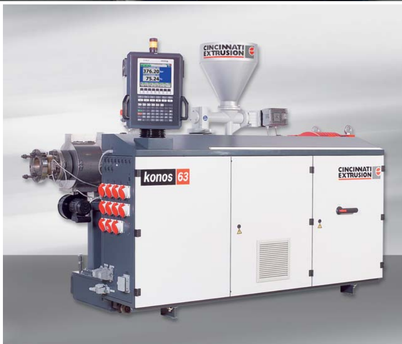
Konos-Doppelschneckenextruder für unterschiedlichste Anwendungen.
